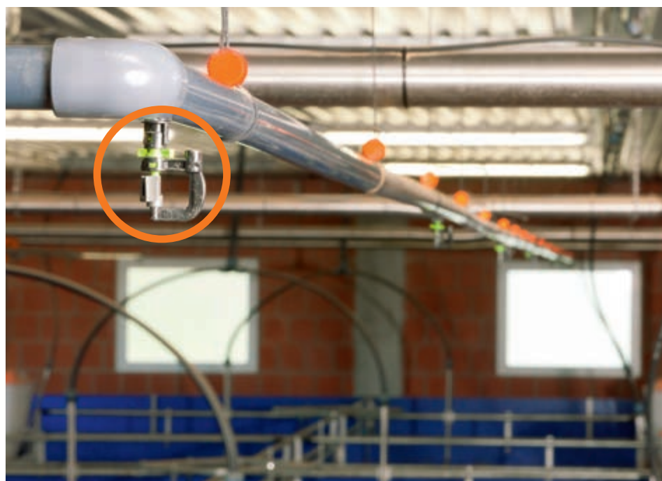
Stationäre Einweichanlage in einem Mastabteil
