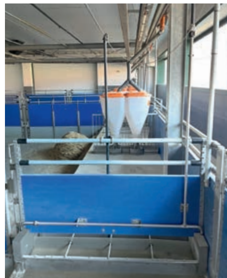
Die spezielle Tränke für das Strohstallsystem Xaletto ist mit einem Füllstandssensor ausgestattet. Das verhindert unnötige Wasserverluste und das Strohbett bleibt trocken.
